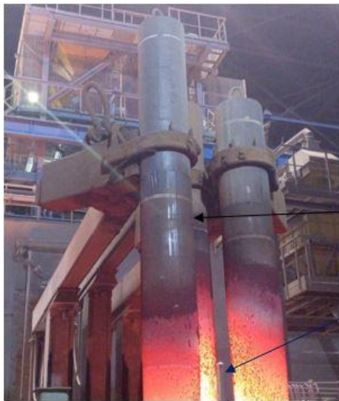
Рисунок 2. «Ступенька» на границе контакта электрода с крышкой УПК
