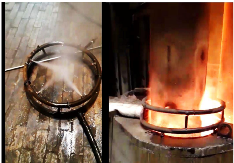
Рисунок 4. Опытно-промышленная установка испарительного охлаждения
